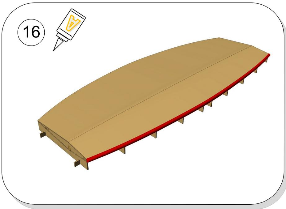
Incollare il bordo di entrata B5-L11 e rifilarlo in testata a filo centina di estremità.
