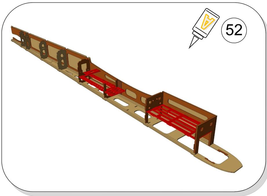
Contemporaneamente inserire ed incollare la piastra LiPo/serbatoio P2-P1, piastra elettronica P2-P2 e fissaggio ala A3-P6
